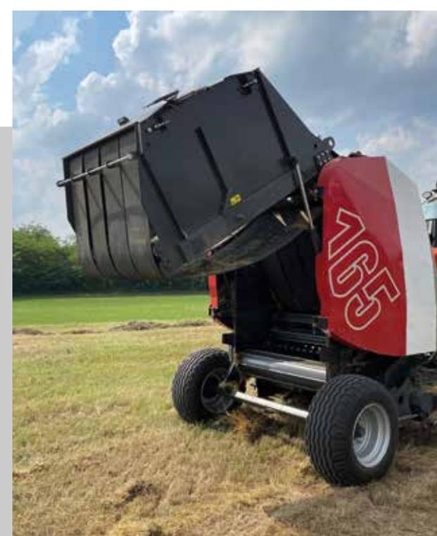
La "Rossa" Rotopressa camera variabile e cuore variabile lavora indistintamente e ottimamente con insilato, paglia o fieno e in condizioni di prodotto non ancora perfettamente pronto da raccogliere. La possibilità di scelta della dimensione del cuore e della densità di pressatura consente una vasta gamma di condizioni di raccolta.
